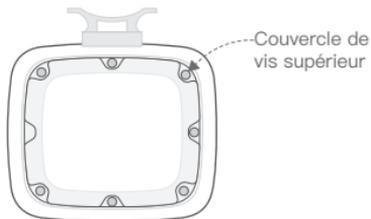
2) Montez le support de montage X2000 dans une orientation verticale sur un mur ou un poteau avec la trousse de montage fournie.
